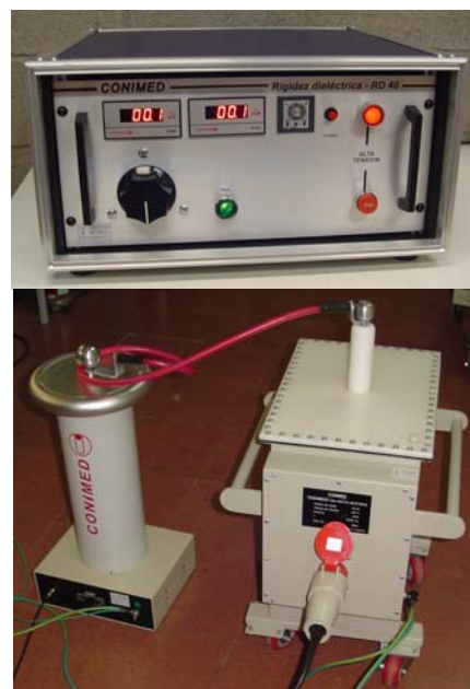
Unidad de Control, Transformador de Alta Tensión y Divisor Resistivo
